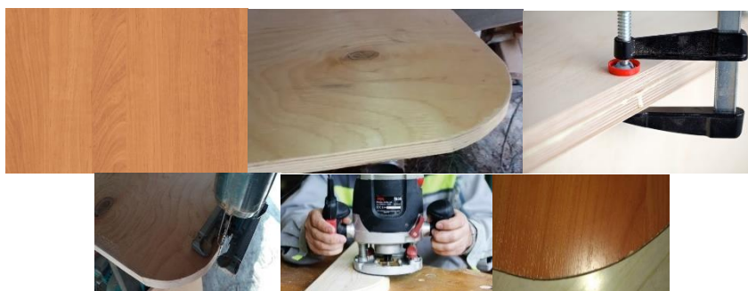
Рисунок 1. Изготовление радиусной детали с помощью жесткого шаблона, лобзика и ручного фрезера
