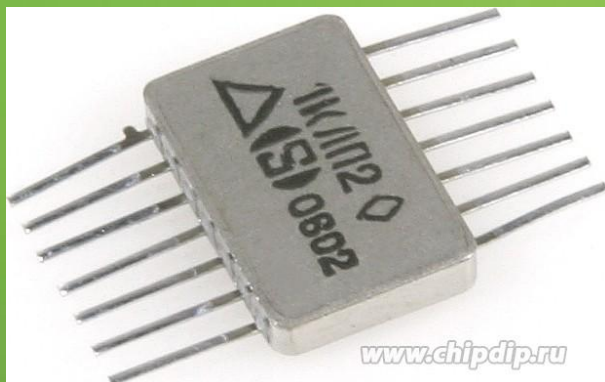
564ЛП2 никель, 4 логических элемента
