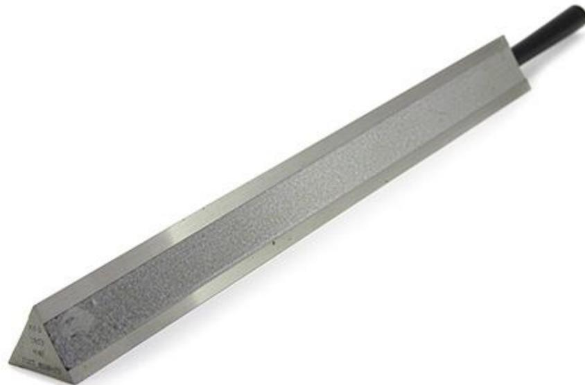
При проверке способом следа рабочим ребром линейки проводят по чистой проверяемой поверхности. Если поверхность прямолинейна, на ней останется сплошной след; в противном случае след будет прерывистым (пятнами).
