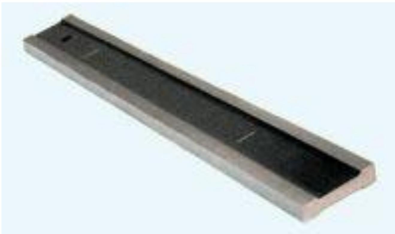
Проверка прямолинейности и плоскостности этими линейками производится по линейным отклонениям и по краске (способ пятен). При измерении линейных отклонений от прямолинейности линейку укладывают на проверяемую поверхность или на две концевые меры одинакового размера. Просветы между линейкой и контролируемой поверхностью измеряют щупом.
