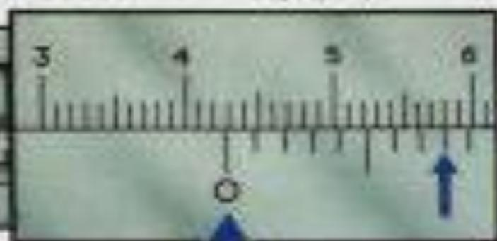
$$42 \text{ мм} + 8 \times 0,1 \text{ мм} = 42,8 \text{ мм}$$
