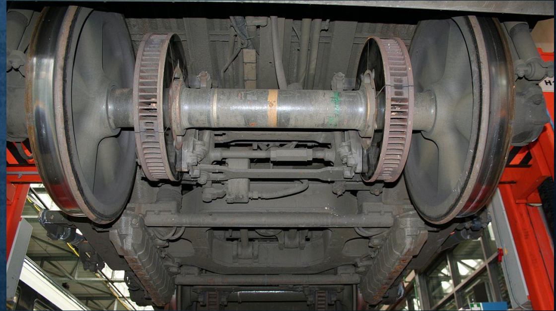
Колёсная пара с двумя тормозными дисками, напрессованными на ось
