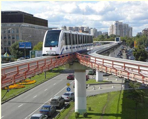
Поезда Московской монорельсовой транспортной системы используют для движения асинхронный линейный двигатель. Статор расположен на подвижном составе, а вторичным элементом служит монорельс.
