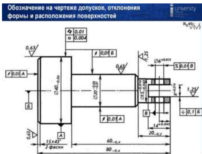
Рисунок 2 – Эскиз детали типа «Вал» для группы 2
