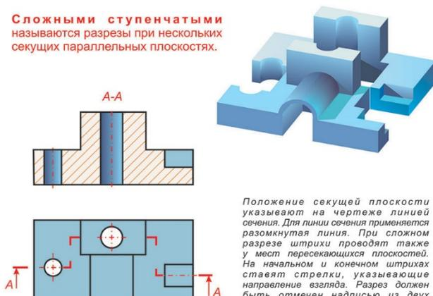
Положение секущей плоскости указывают на чертеже линией сечения. Для линии сечения применяется разомкнутая линия. При сложном разрезе штрихи проводят также у мест пересекающихся плоскостей. На начальном и конечном штрихах ставят стрелки, указывающие направление взгляда. Разрез должен быть отмечен надписью из двух отдельных букв, написанных через тире, например, А-А.
